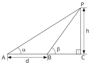
Para medir a altura de uma torre localizada em um terreno plano e horizontal, adotou-se o procedimento a seguir, que se encontra esquematizado na figura. Escolheram-se, no terreno, dois pontos A e B distantes d metros um do outro e alinhados com a base da torre C. Do ponto A, via-se o ponto P mais alto da torre, sob um ângulo de  $\alpha$  graus com o plano horizontal. Do ponto B, via-se o ponto P sob um ângulo de  $\beta$  graus com o plano horizontal. A altura h da torre é, em metros,
