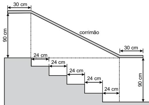
Na figura acima, que representa o projeto de uma escada com 5 degraus de mesma altura, o comprimento total do corrimão é igual a:
