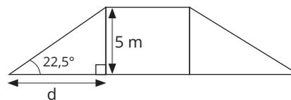
Para facilitar o trânsito em um cruzamento muito movimentado, será construída uma ponte sobre a qual passará uma das vias. A altura da via elevada, em relação à outra, deverá ser de 5,0m. O ângulo da inclinação da via elevada, em relação ao solo, deverá ser de  $22,5^\circ$ . A distância  $d$ , em metros, onde deve ser iniciada a rampa que dará acesso à ponte, medida a partir da margem da outra via, conforme mostra a figura, deverá ser de:
