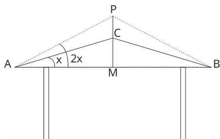
Devido à pouca inclinação, o telhado do depósito, representado pela figura, apresentava goteiras. Foi consultado um engenheiro que sugeriu levantar a cumeeira, de modo que o ângulo  $x$  passasse para  $2x$ . Sabendo que as medidas de  $AM$  e  $CM$  são, respectivamente, 12 m e 2 m, qual será, aproximadamente, a medida de  $PC$ ?
